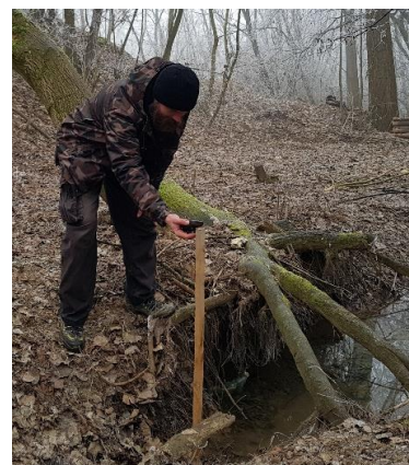
Figura 49 - Proiectarea unui sistem simplu de măsurare pentru a monitoriza colmatarea rezervorului din spatele barajelor din bușteni, situate în șanțurile de eroziune, folosite ca și capcane de sedimente. (Fotografie: WWF HU)
